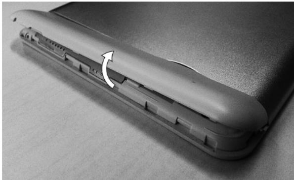
тем снять ее. Внешний вид отсека со слотами для SIM-карт представлен на рисунке.
