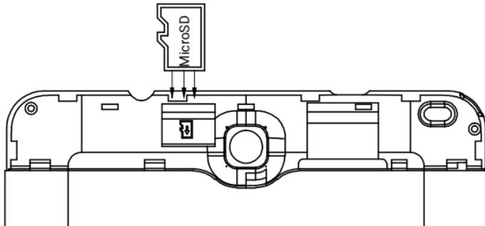
Для извлечения карты памяти выберите пункт "Извлечь SD-карту" в настройках планшетного ПК (Настройки->Память->Извлечь SD-карту), затем нажмите "OK" в появившемся окне, после чего извлеките карту из слота планшетного ПК. Запрещается извлекать носитель из слота планшетного компьютера, если запущенные на планшетном компьютере приложения используют информацию, хранящуюся на внешнем носителе. Это может привести к поломке и выходу из строя как носителя информации, так и планшетного компьютера.
